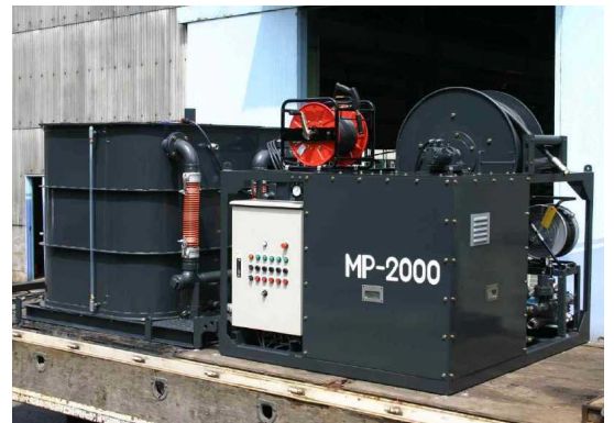
写真-2 削孔水ユニット MP-2000
