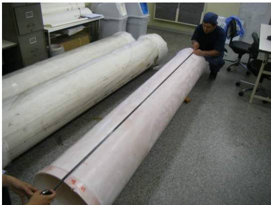
写真20 軸方向寸法確認状況
