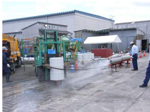
写真 1 5 耐高压洗浄性試験状況
