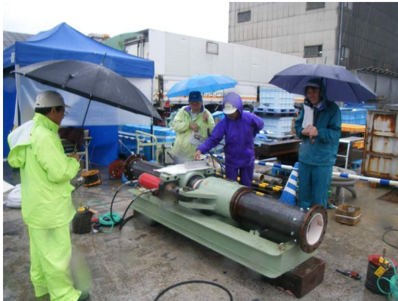
写真 1 2 地盤追従性試験状況
