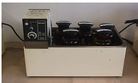
写真6 耐薬品性試験の状況
