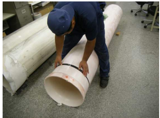
写真21 内径方向寸法確認状況
