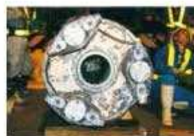
リターン回収機カッターフェイス(500倍)
