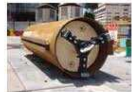
密閉型リターン回収推進機 (外径φ812mm強靱鋼管挿入時)
