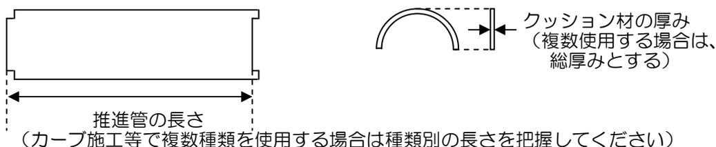
図.3 推進管の長さ、クッション材の厚み
