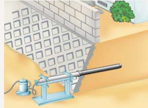
水抜き管埋設工事
