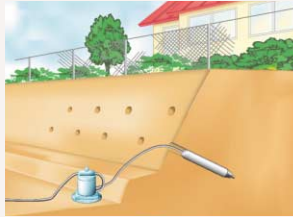
土留めアンカー打ち工事
