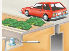
下水管理設工事
