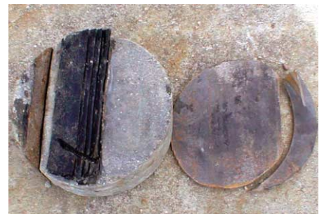
削孔コアと鋼製カラー
