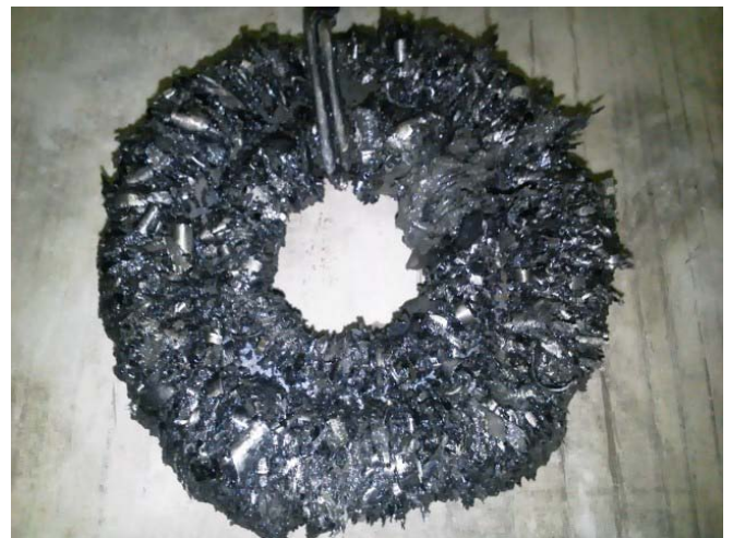
排出した金属片。円形の磁石に付着させたもの
