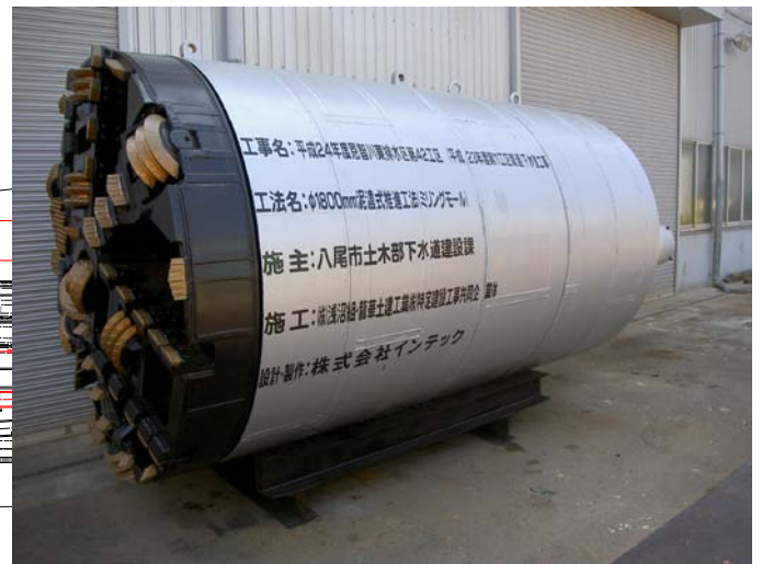
φ 1800mm ミリングモールド掘進機
