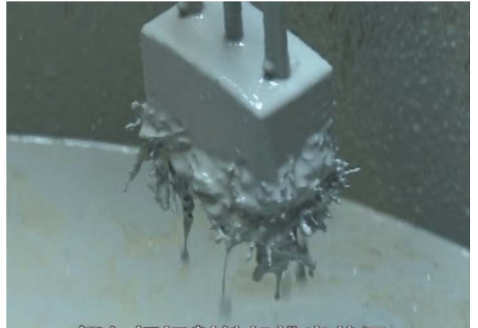
2012.02.03 真空排泥タンク内へ磁石を投入し引き上げた状態写真 排出された泥土内から切削した金属粉の付着を確認
