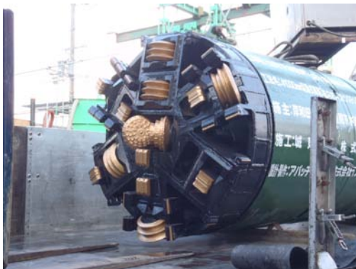
\phi 1000\text{mm} ミリングモール掘進機
