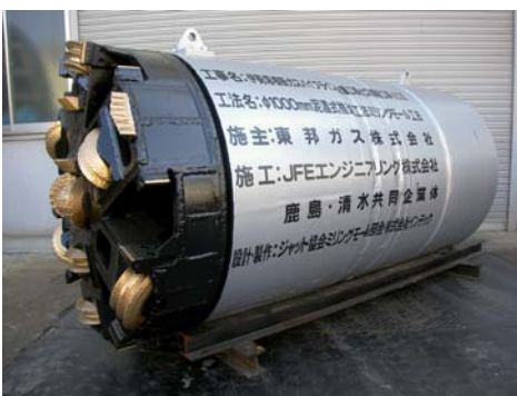
\phi 1000\text{mm} ミリングモール掘進機
