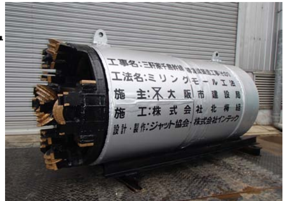
\phi 800\text{mm} ミリングモール掘進機
