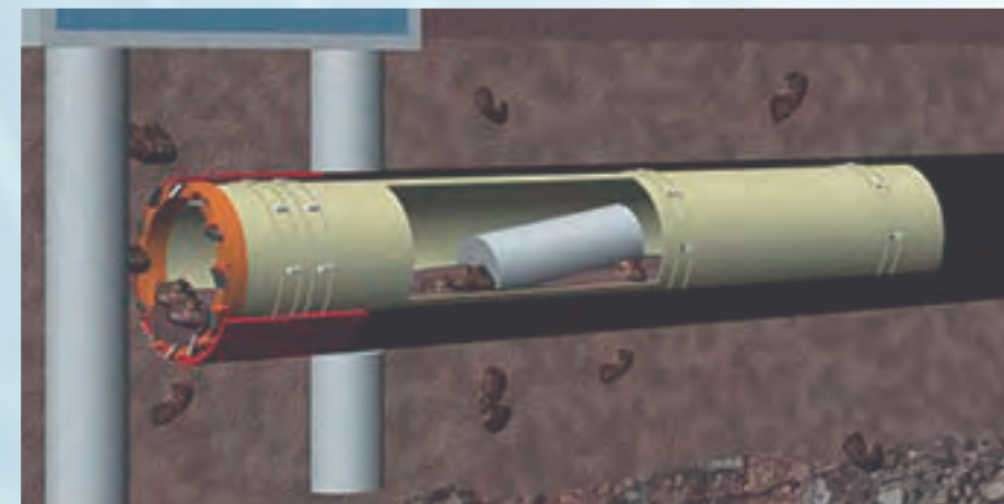
■ コンクリート杭切断状況
