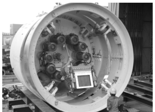
写真-4.5 ボルト接合された掘進機の外殻構造
