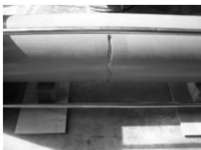
目視にて切れ込み部分の漏水がないことを確認
