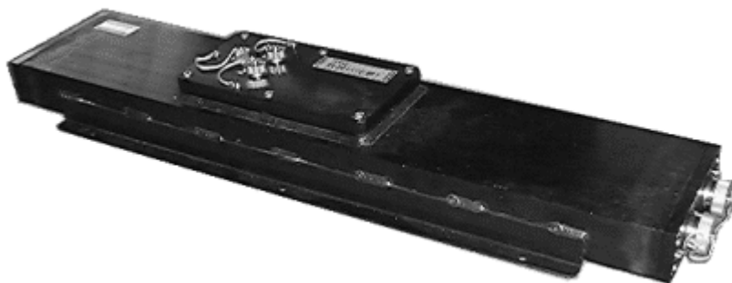
写真 2.3-4 基準プリズム制御ユニット部
