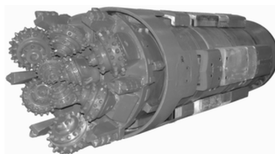
写真 1.3-3 DL70N (反力板方式) 先導体
