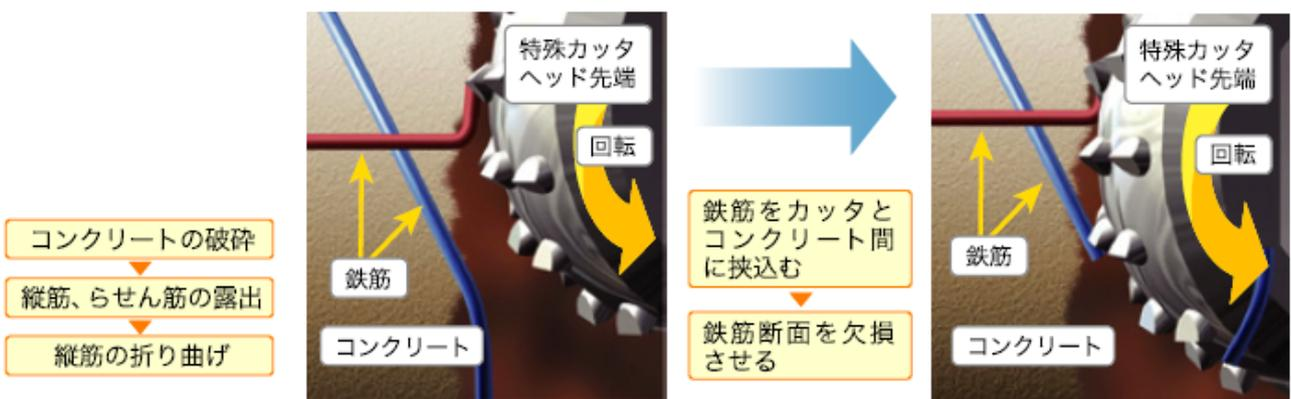
図 1.7-3 鉄筋コンクリート管の破碎メカニズム
